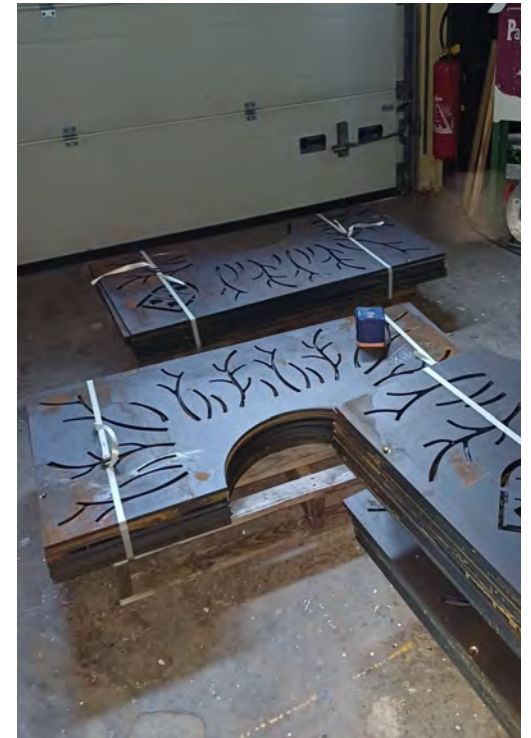
De belles grilles d'arbre en corten, découpées au laser et ornées du blason de la commune agrémentent joliment les pieds des arbres de la rue
